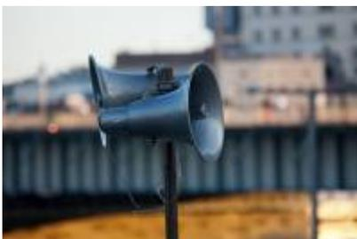
Für die Installation werden Druckkammerlautsprecher verwendet
